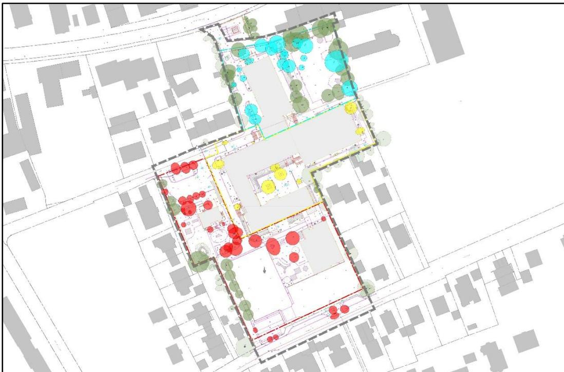
**Abb. 9:** Baumfällungen in den Bauabschnitten (rot: Bauabschnitt 1, gelb: Bauabschnitt 2, cyan: Bauabschnitt 3, grün: Bäume die im Geltungsbereich erhalten werden), Auszug aus Planung IB Kübert (KIS\_3\_AUA\_BT\_LA\_001\_000\_Bestand mit Baumfällungen vom 20.12.2023) Plangrundlage © LVG-Bayern (Originalmaßstab 1/1.000)
